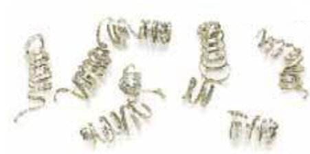
Свободно намотанная (витая) стружка идеальные условия резания
