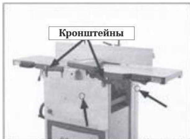
Рис. 6. Расположение передних и задних такелажных отверстий
