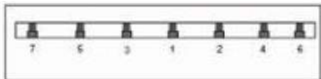
Рис. 42. Последовательность затяжки прижимной планки
