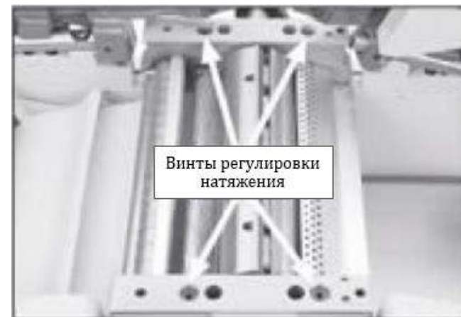
Рис. 57. Винты регулировки натяжения пружины
