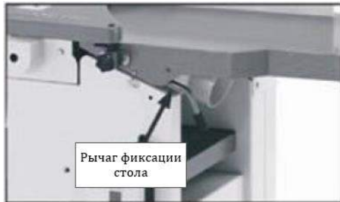
Рис. 21. Рычаг фиксации подводного стола
