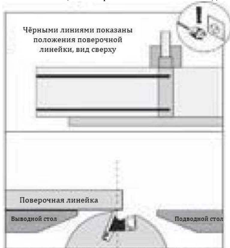
Рис. 38. Проверка высоты ножа поверочной линейкой
