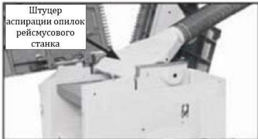
Рис. 23. Наладка штуцера аспирации опилок рейсмусового станка
