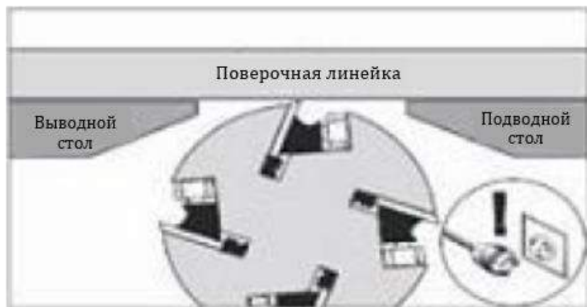
Рис. 44. Установленные вровень подводной и выводной столы
