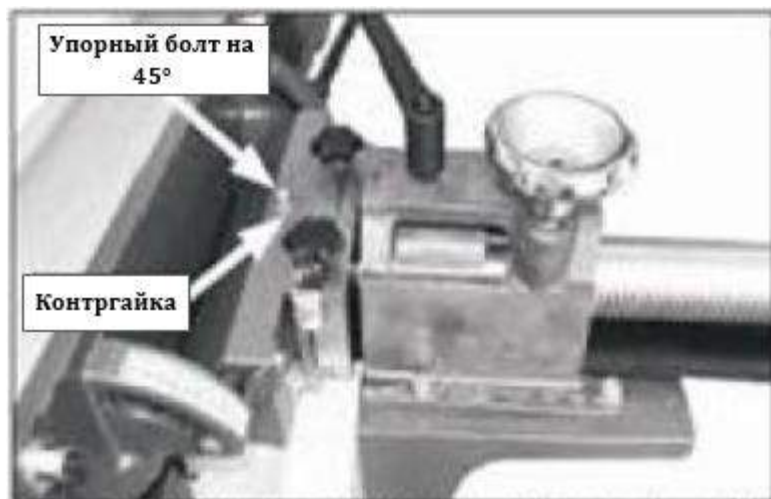
Рис. 50. Регулировка параллельного упора под 45° наружу
