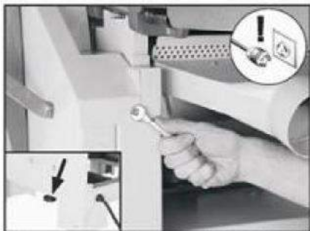
Рис. 25. Выворачивание винтов с крышки клиноремённой передачи и рукоятки натяжения ремней (в комплекте)
