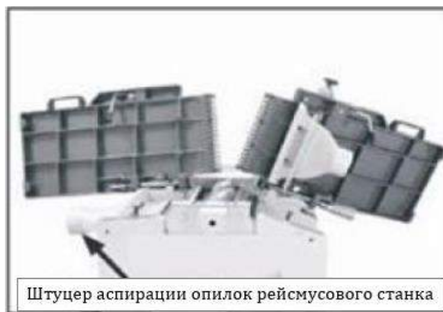
Рис. 13. Штуцер аспирации опилок рейсмусового станка в нижнем положении
