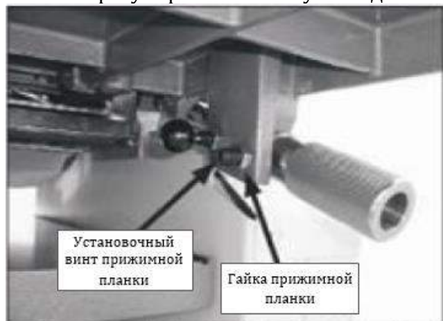
Рис. 52. Регулировка прижимной планки подводного стола
