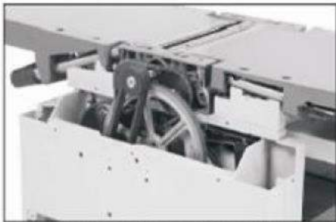
Рис. 46. Снятые параллельный упор и крышка клиноремённой передачи
