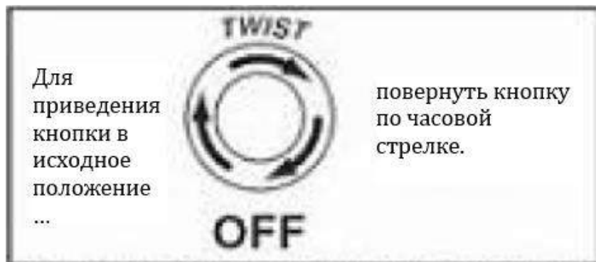
Рис. 14. Приведение кнопки аварийного отключения в исходное положение
