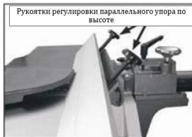
Рис. 18. Параллельный упор, установленный заподлицо со столом под углом 45^\circ
