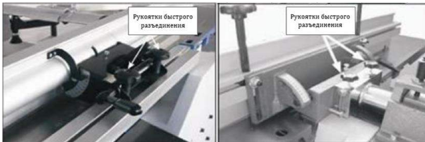
Рис. 20. Снятие параллельного упора
