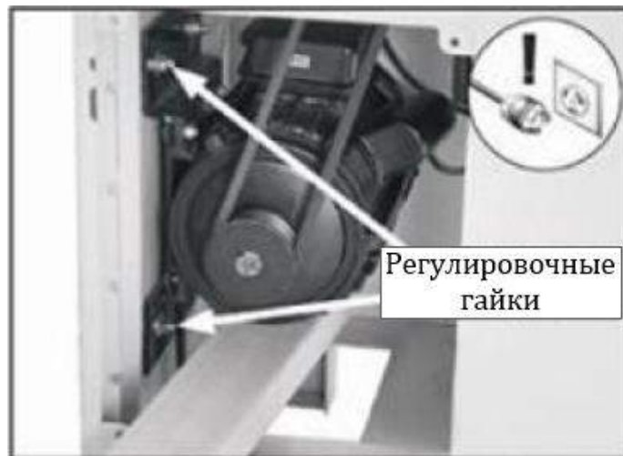
Рис. 26. Снятие натяжения клиновых ремней
