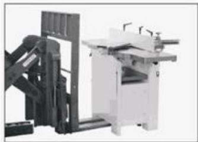
Рис. 5. Поднятие станка вилочным погрузчиком
