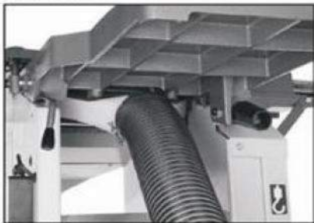
Рис. 12. Рукав аспирации опилок, закреплённый на фуговальном станке
