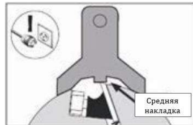
Рис. 37. Типовой калибр, помещённый на нож режущего вала
