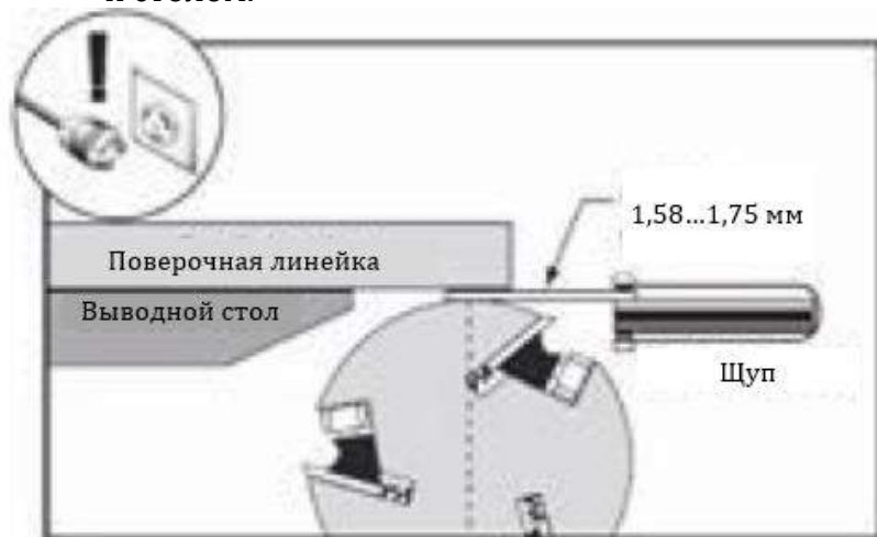
Рис. 32. Проверка щупом высоты выводного стола относительно режущего вала
