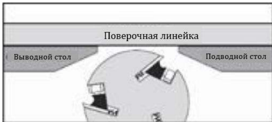
Рис. 34. Установленные вровень подводной и выводной столы
