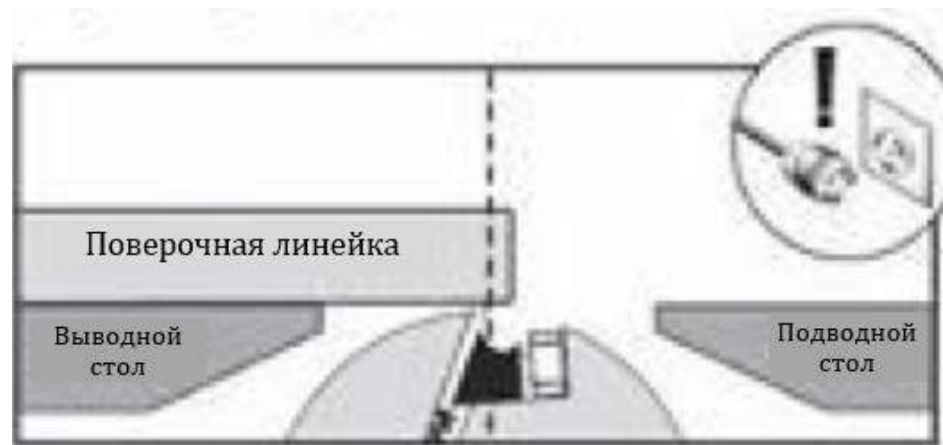
Рис. 9. Использование поверочной линейки для выравнивания выводного стола
