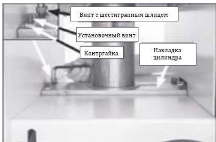
Рис. 56. Регулировка параллельности стола
