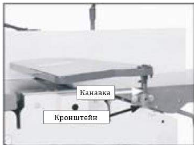
Рис. 10. Установка ограждения режущего вала
